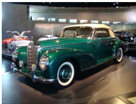
Mercedes Benz 300 S Coupe, 1951 – 1955, 3 Liter Hubraum, 150 PS, 175 Km/h, 560 Stück produziert
